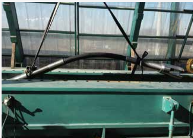
1) 360톤 조립인장 시험체(정착구+타이케이블) 장착 준비
