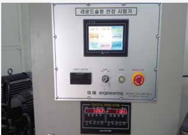
3) 360톤 조립인장 시험 결과치 (3,262KN / 합격)
