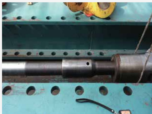
4) 인장시험 후 조정단 상태(핀, 소켓, 턴버클 이상 없음)
