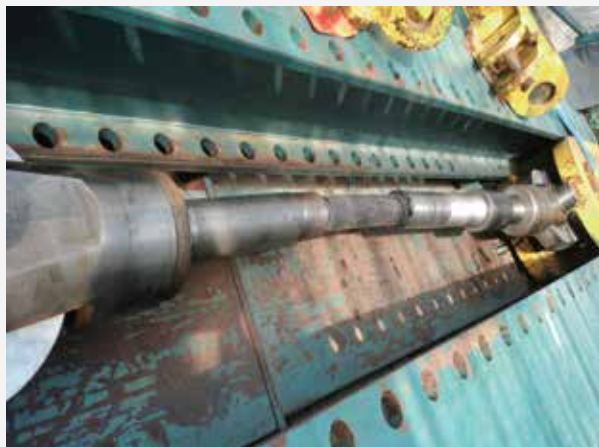
2) 360톤 조립인장 시험체 장착 상태
