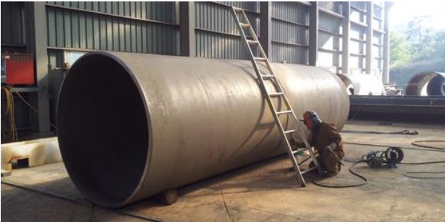
STEP 4 : Main Pipe 조립, 용접
