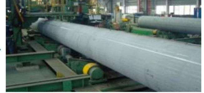
STEP 3 : Pipe 밴딩
